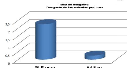
Imagen 1: Holgura de las válvulas después de 20 horas con aditivo, comparada con el desgaste previamente medido.
