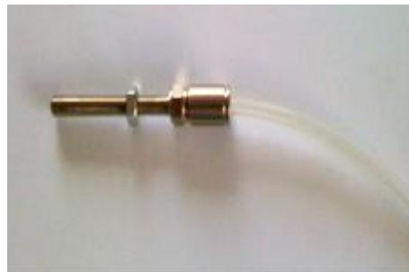
**Einleitung mittels Additivweiche in den Gummischlauch nach dem Gasinjektor:**
