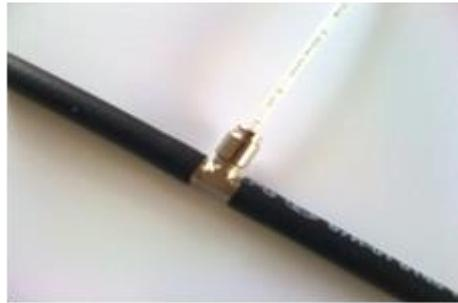
**Einleitung mittels Additivweiche in PA-Schlauch (6mm) nach dem Gasinjektor (inline)**
