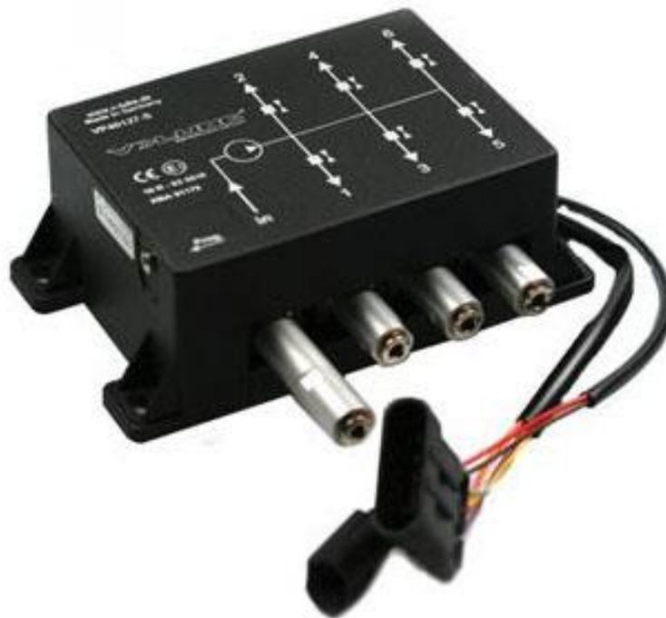
Die Dosiereinheit ist als 4 oder 6 Zylindermodell lieferbar und komplett in einem kompakten Druckgussgehäuse incl. der Controllerplatine vergossen. Es gibt keinerlei Vorgaben hinsichtlich der Einbaulage. Durch einen eingebauten Druckfühler überwacht das System alle Mikroventile sowie die Pumpe auf korrekte Funktion. Die Leitungsanschlüsse müssen nur eingesteckt werden.
