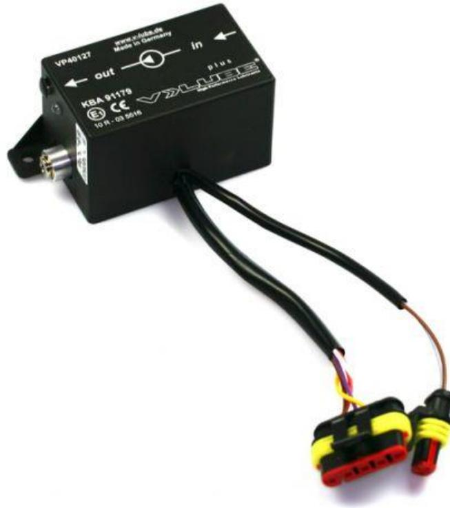
Die Dosiereinheit ist in einem kompakten Gehäuse incl. der Controllerplatine vergossen. Die Einbaulage kann beliebig gewählt werden. Die Leitungsanschlüsse sind als Schnellsteckverschraubungen ausgeführt. Der Programmieranschluss befindet sich oberhalb der Saugseite und ist durch einen Einstecknippel vor Verschmutzung und Feuchtigkeit geschützt.
