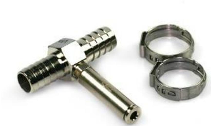
Bei gasbetriebenen Fahrzeugen mit Verdampferanlagen kann das Additiv mittels der Additivweiche nach dem Verdampfer in die Niederdruckgasseite eingespritzt werden. Es stehen Nennweiten von 10,12, 14 und 16 mm Schlauchanschlüssen zu Verfügung. Die Weiche wird incl. Schellensatz geliefert und einfach durch Trennen des Gasschlauches nach dem Verdampfer in den Gasweg eingebaut.
