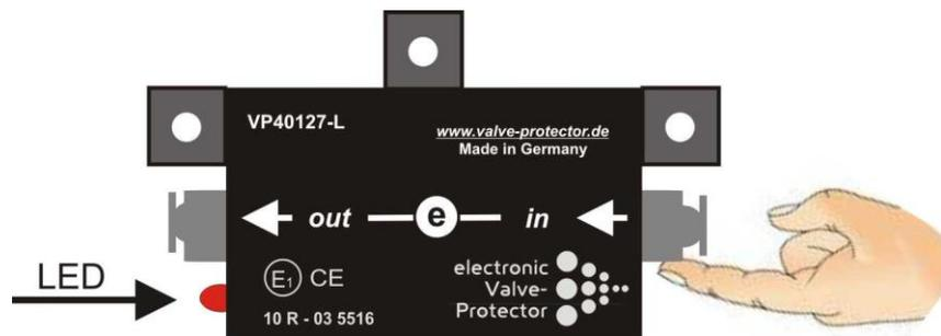
**Schritt 1:** Starten Sie das Fahrzeug und aktivieren Sie die Gasanlage. Das Dosier-Modul wird jetzt mit Spannung versorgt und bleibt 30 Sekunden lang im Set-Up Bereitschaftsmodus (LED leuchtet gelb). **Bei jedem Neustart bleibt das Modul für 30 Sekunden im Set-Up Bereitschaftsmodus.**
