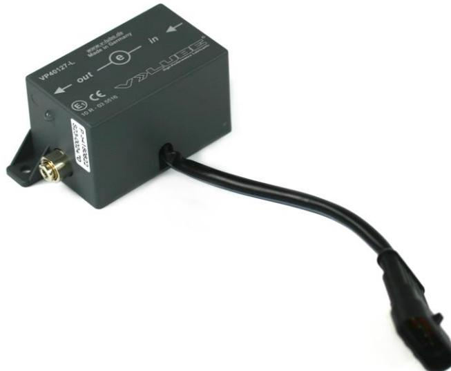
Die Dosiereinheit ist in einem kompakten Gehäuse inkl. der Controllerplatine vergossen. Die Einbaulage kann beliebig gewählt werden. Die Leitungsanschlüsse sind als Schnellsteckverschraubungen ausgeführt. Die Mengeneinstellung erfolgt einfach über das Berühren der metallischen Schlauchanschlüsse (kapazitiver Taster).
