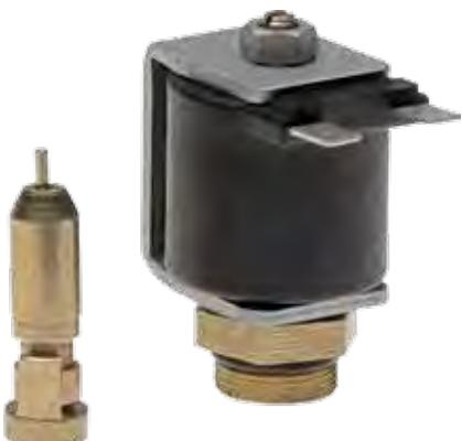
Gruppo bobina completo 12V/24V, connessione elettrica con 2 faston 6,35x0,8, nucleo mobile per sedi, tenuta diametro massimo 6,35mm. Diametro interno bobina da 12mm. Versione pilotata su richiesta.
