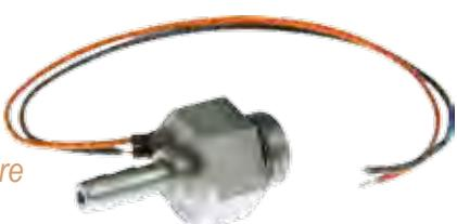
Raccordo per tubo di gomma interno diametro 5 o 6 mm per presa segnale di pressione all'uscita dell'iniettore, con integrato sensore di temperatura NTC 4.7 kOhm per iniettori IG1, IG1 Apache e IG5 Noumea. Disponibile versione con connettore AMP.
