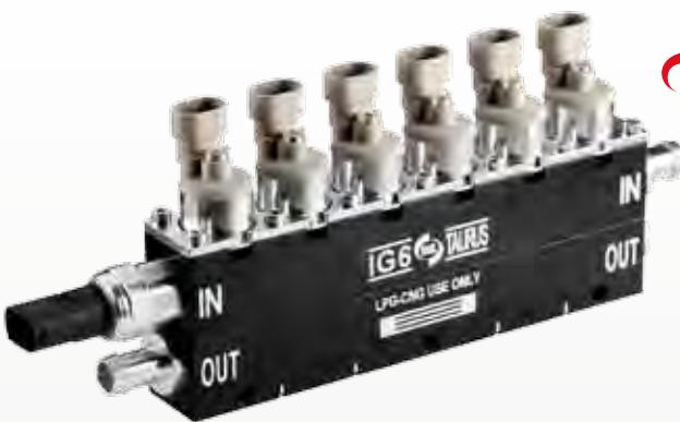
Dosatore single point per gpl/metano fase gassosa per veicoli pesanti. Bobine aventi connettore integrato 2 vie a tenuta stagna compatibile amp/del phi. Corpo in alluminio anodizzato. Assicura elevate prestazioni in termini di velocità, portata e durabilità, con ridotta sensibilità allo sporco. Realizzazione compatta e ampia flessibilità di installazione sul veicolo. Varianti disponibili anche con 3 e 5 bobine.
