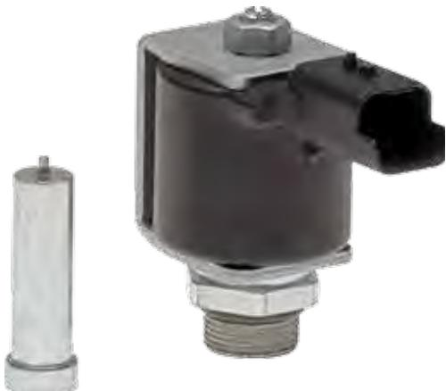
Gruppo bobina completo 12V, connettore integrato Sicma 2, canotto per applicazione su sedi, valvole aventi filetto da M16x1, nucleo mobile per sedi tenuta diametro massimo 6,35mm. Diametro interno bobina da 12mm.
