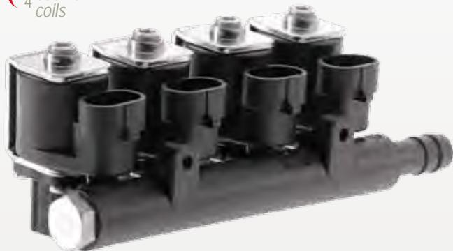
Rail Iniettore per GPL e Metano fase gassosa. Unica versione con corsa da 0,6mm. Bobine aventi connettore integrato 2 vie a tenuta stagna compatibile AMP/Delphi. Corpo in materiale polimerico ad alta resistenza meccanica e termica. Iniettore modulare in due configurazioni: singolo con manifold separato o montabile su rail. Scarsamente sensibile allo sporco.
