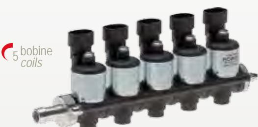
Rail iniettore per Gpl e Metano fase gassosa. Unica versione con corsa da 0,6mm. Bobine aventi connettore integrato 2 vie a tenuta stagna compatibile Amp/Delphi. Corpo in materiale polimerico ad alta resistenza meccanica e termica. Tecnologia di costruzione atta ad ottenere elevate prestazioni in termini di velocità e durabilità. Alta stabilità e ripetitività dei flussi interni.
