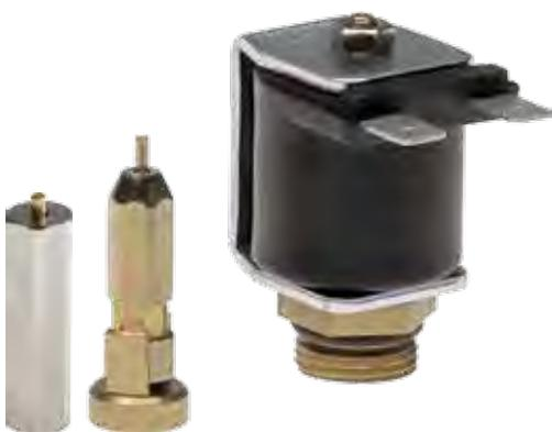
Gruppo bobina completo 12V. Cannotto per applicazione su sedi, valvole aventi filetto da M12x1 e M15x1,25, nucleo mobile per sedi. tenuta diametro massimo 6.35mm. Diametro interno bobina da 9.3mm. Disponibile nelle versioni ad azionamento diretto o pilotato.
