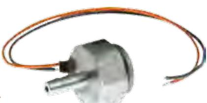
Raccordo per tubo di gomma interno diametro 5 o 6 mm per presa segnale di pressione all'uscita dell'iniettore, con integrato sensore di temperatura NTC 4.7 kOhm per iniettore IG3 Horizon e IG7 Navajo. Disponibile versione con connettore AMP.
